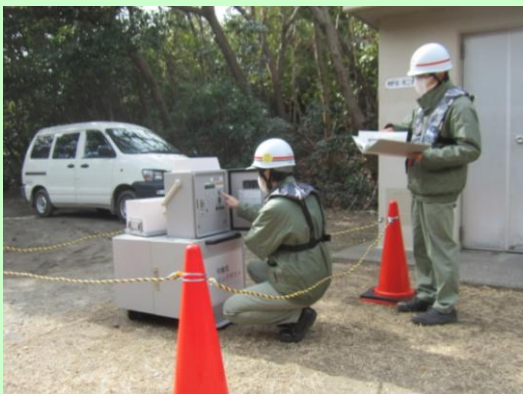
可搬型モニタリングポストを 用いた代替測定
