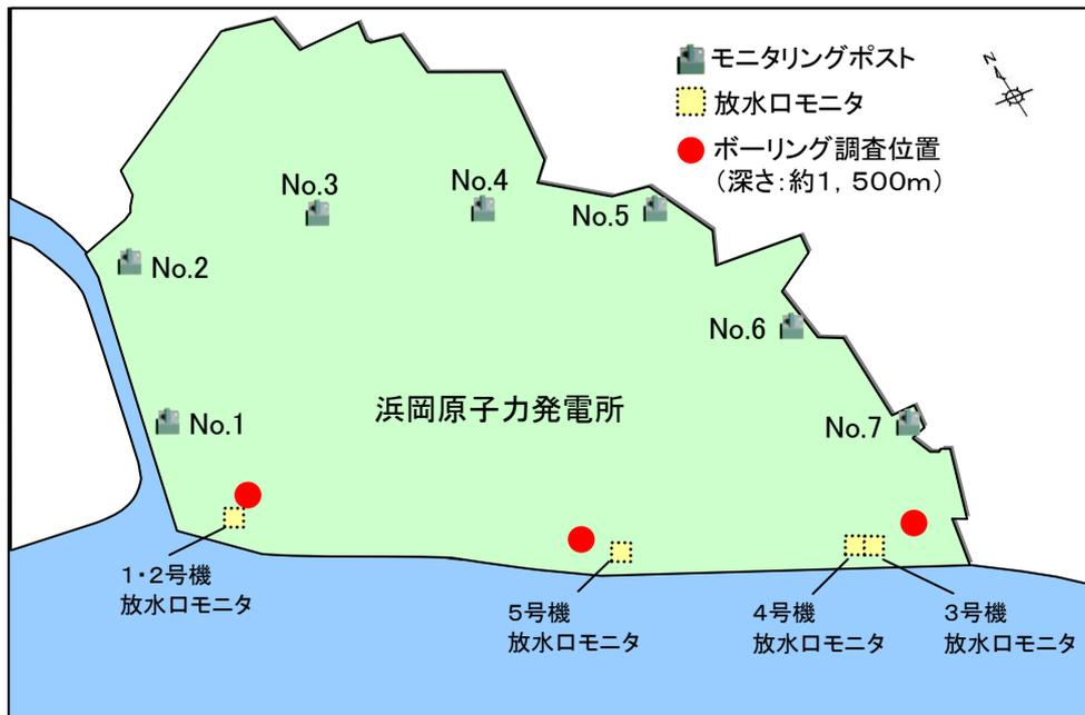
※1 地下構造特性調査は、既往の調査結果の信頼性を確認するとともに、知見をより一層充実させるために実施していたもので、調査項目は、微動アレイ観測、微小地震観測、陸域・海域弾性波探査およびボーリング調査です。
