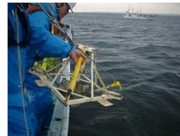
海域部での採取の様子 (採泥器を使って船上から採取します)
