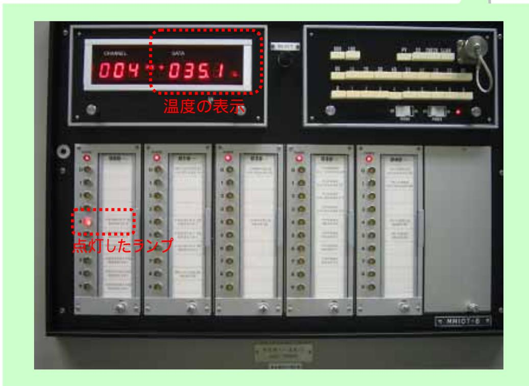
主蒸気隔離弁下流側の主蒸気管周辺に温度検出器を40個設置し、主蒸気管からの蒸気漏えいを監視しています。
