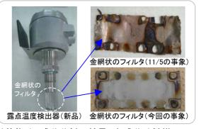
点検で確認した1~2ミリメートル程度の複数の黒い付着物は、成分分析の結果、主成分は触媒であり、その他に付着面にゴム等の有機物が含まれていることを確認しました。調査の結果、この有機物は起動前に行った排ガス再結合器の分解点検時に、触媒の取扱いに使用したゴム手袋と成分が一致することを確認しました。
