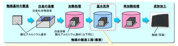
「温水洗浄」とは、触媒の製造工程(白金の添着工程)で触媒基材に付着した塩素成分を除去するため、高温水で洗い流す工程です。
