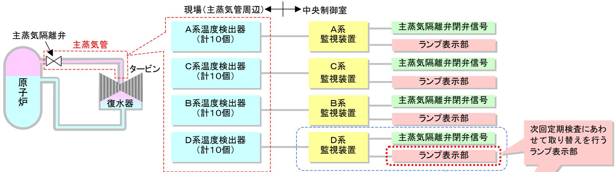
主蒸気隔離弁下流側の主蒸気管周辺に温度検出器を40個設置し、主蒸気管からの蒸気漏えいを監視しています。
