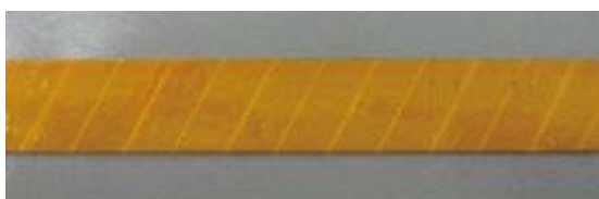
樹脂テープを巻く絶縁を施した線材の外観
