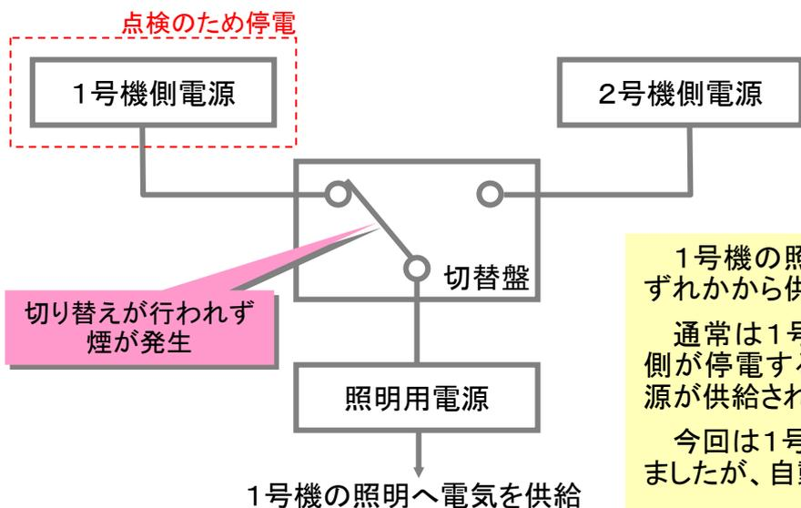
1号機の照明用電源は、1号機または2号機のいずれかから供給できるようになっています。
