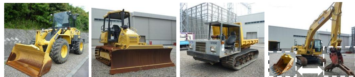
ホイールローダー ブルドーザー クローラーキャリア 油圧ショベル (アーム先端は取替可能)
