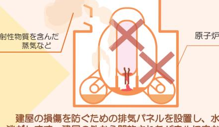
建屋の損傷を防ぐための排気パネルを設置し、水素を外へ逃がします。建屋の外から開放されたパネルに向かって放水することで、原子炉建屋から発電所敷地外へ放射性物質の拡散を抑えます。また、放水された水の海洋への拡散を抑えるための設備を設けます。
