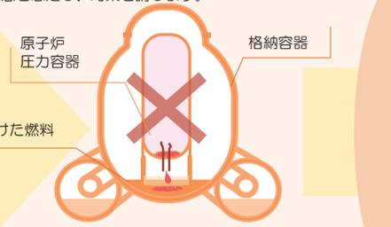
容器の熱を逃がすとともに、異常な圧力の上昇を防止するための装置を設置し、格納容器が破損するのを防止します。
