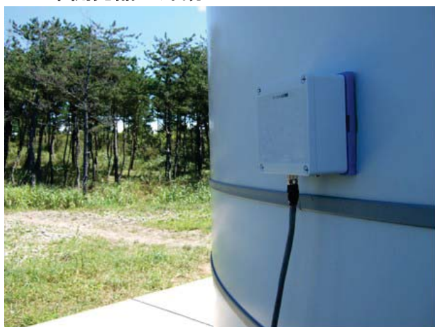
取り付け写真（磁界センサと落雷検出部）
