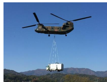
空輸型大型発電機車の空輸訓練
