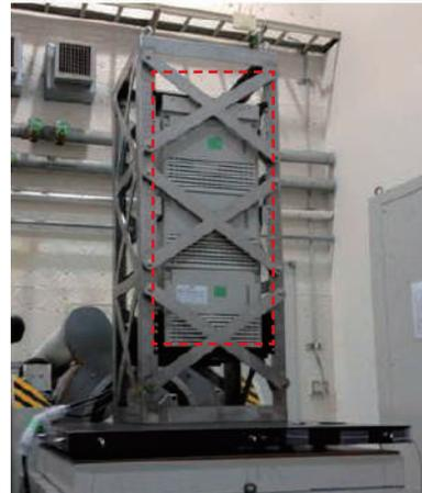
通信装置 (IP-MUX) 加振試験の様子
