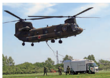
陸上自衛隊との空輸型高圧発電機車の懸吊訓練
