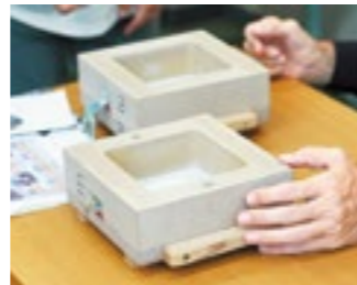
一般向けに、工場見学や鑄造体験も実施している。写真は、体験用の木型。ここに専用の砂を詰め鑄型を作り、溶かした材料を流し込む。(体験では鉄のかわりに融点の低い錫を使用)
