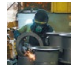
型のつなぎ目などにできる余分なでこぼこを手作業で丁寧に削る。
