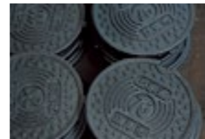
一般向けに、工場見学や鑄造体験も実施している。写真は、体験用の木型。ここに専用の砂を詰め鑄型を作り、溶かした材料を流し込む。(体験では鉄のかわりに融点の低い錫を使用)
