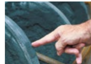
冷えて固まった鉄を鑄型から取り出したものの。こびりついている砂はショット球と呼ばれる小さな球を当てて除去する。
