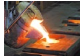
溶けた鉄を専用のバケツで運び、砂でできた型(鑄型)に流し込む。写真はマンホールの製造風景。
