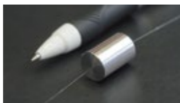
中心に0.2mmの真っ直ぐな穴を開け、糸を通した円柱の金属。技術力の高さがわかる。
