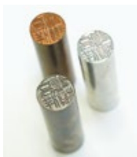
タングステン(手前)、銅(奥)、アルミ(右)でつくった印鑑。持ったときの重さの違いに驚く。(タングステンは、アルミの7倍の比重)
