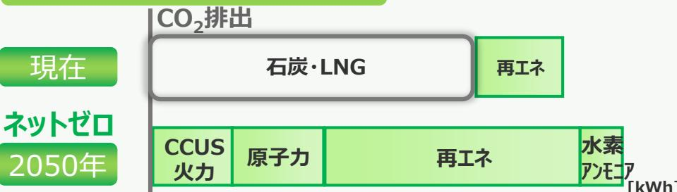
\* Carbon dioxide Capture, Utilization and Storage の略 二酸化炭素を分離・回収し、有効利用又は貯留する技術
