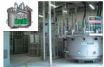
SMES (5000kW1秒間補償) 装置の実証試験
