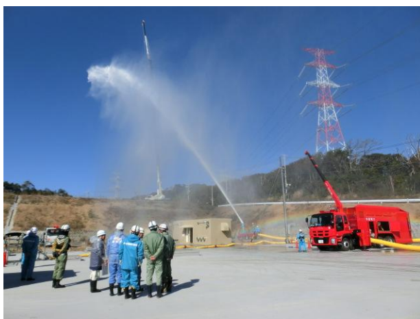
可搬型原子炉建屋放水設備 点検の様子
