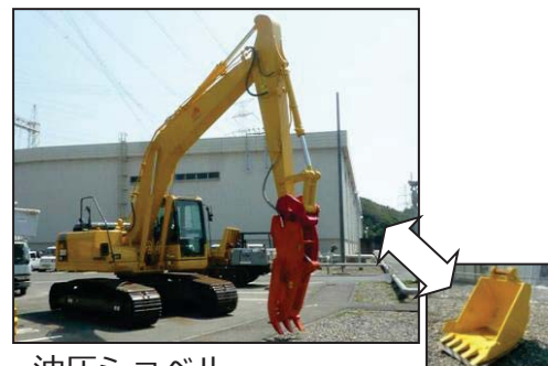
油圧ショベル (アーム先端は取替可能)
