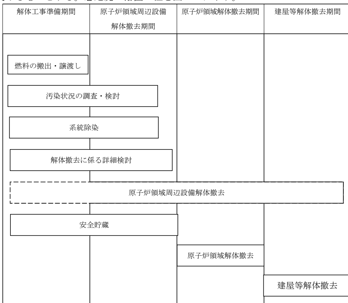
図15 想定廃止措置工程
