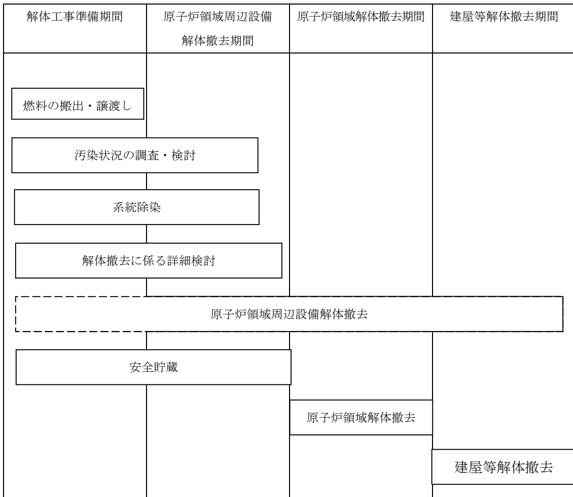
図15 想定廃止措置工程
