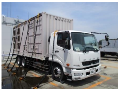
可搬型窒素ガス発生設備
