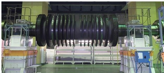
タービンロータ車軸の写真(1軸)
