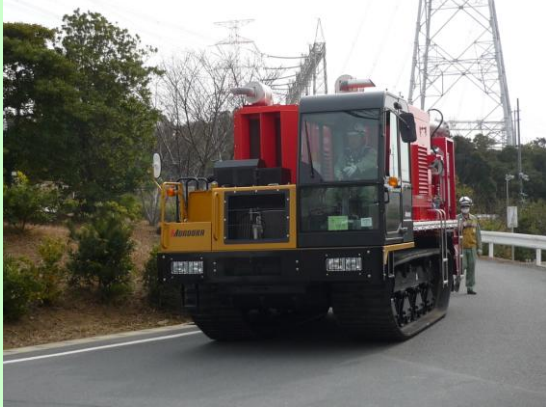
可搬型注水ポンプの設置の準備状況
