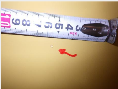
①水滴の付着が確認されたドラム缶(3/1確認)
