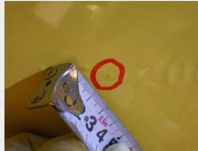
②塗装の膨らみが確認されたドラム缶(3/6確認)
