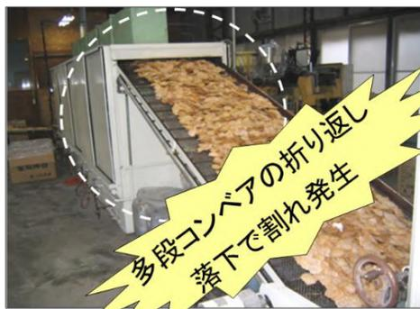
攪拌と落下搬送時にえびせんが割れる。熱風乾燥で50分、多段コンベア炉を使用。
