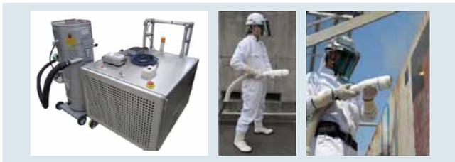
第1図 ポータブルレーザー塗膜除去装置
