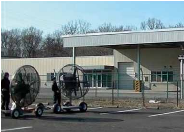
第3図 耐風速試験
