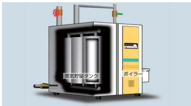
第2図 開発品の内部構造
