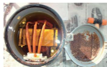
第3図 バランサ内部の発錆状況
