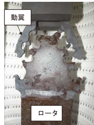
第7図 大型クリープ試験片の破断状況
