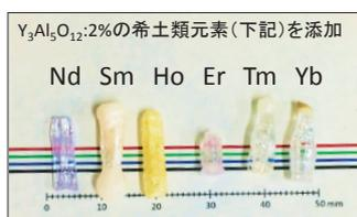
製作した結晶(シンチレータ)の例
