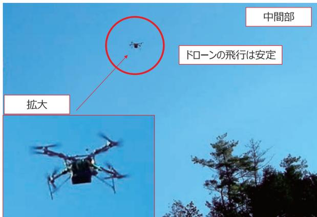
第2図 飛行運搬試験の様子
