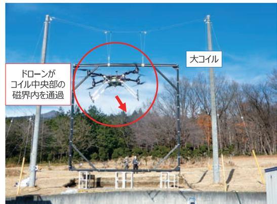
第4図 磁界影響試験の様子 (コイルは垂直配置)
