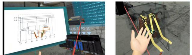
第5図 回路図と3Dモデルでの測定経路確認補助
