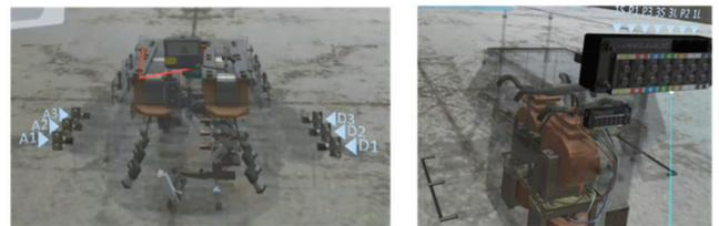
第6図 外箱透明化 (左:開閉器(RS3)、右:6kV VCT)
