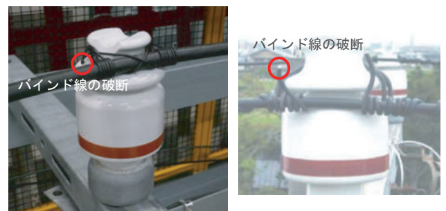
(1) 振動試験での破断例
