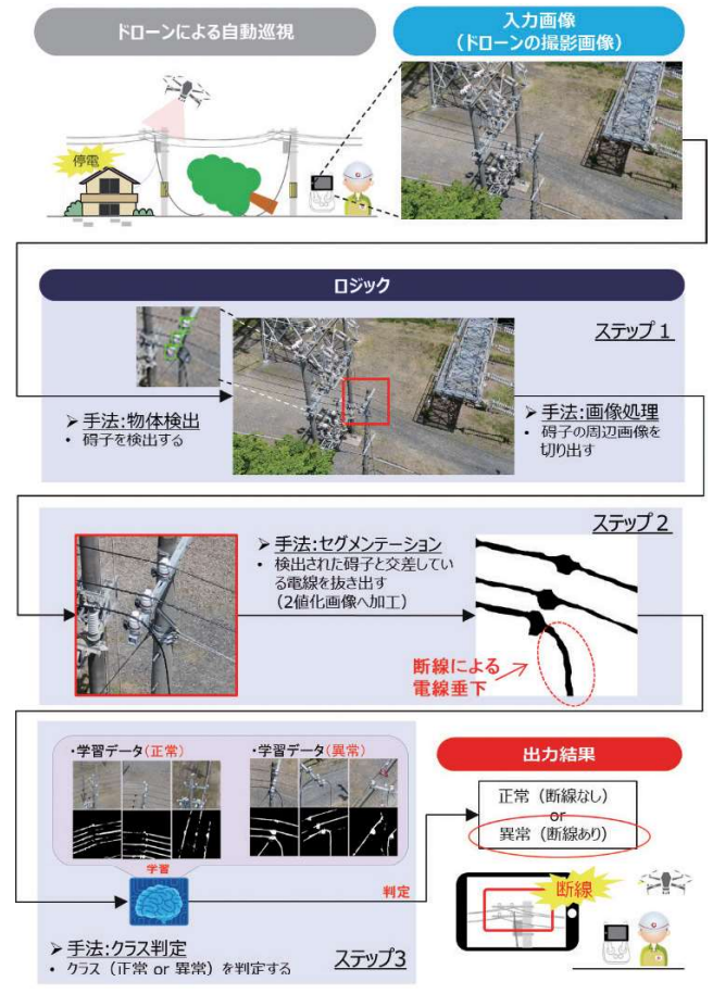
第4図 ドローン撮影画像からの断線有無の判定ロジック
