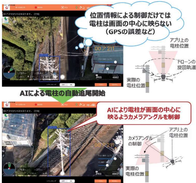
第3図 実機検証にてカメラアングルを自動制御する様子 (上図：GPS位置情報を元にしたカメラ制御時 下図：AIを活用し補正したカメラ制御時)
