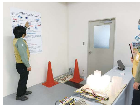
ミニチュア電力設備によるマイクログリッド模擬試験
