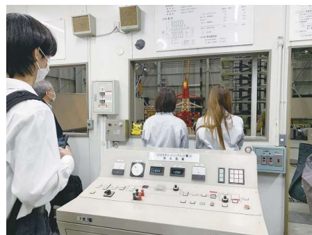
模擬送電鉄塔の落雷実験
