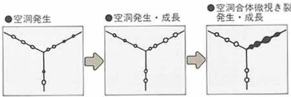
第4図 クリープ劣化の組織変化
