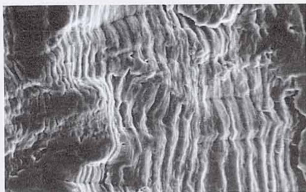
第1図 金属の疲労破断面(電子顕微鏡 1000倍)
