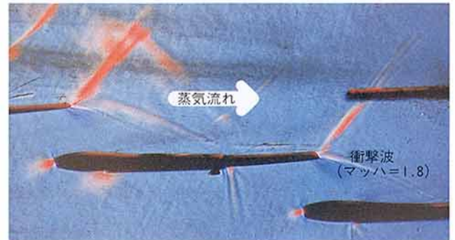
第1図 翼先端部高速蒸気流の確認試験
