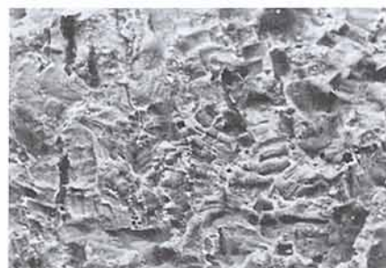
第4図 酸化被膜付炭素鋼板（溶解試験後表面反射電子像）
