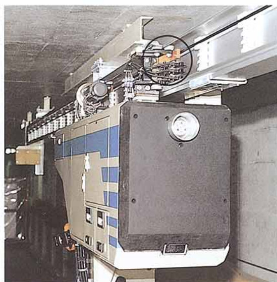
モノレール側とロボット側のアンテナ間(数mm間隔)で、微弱な電波(VHF帯)により、カラー映像・センサ情報を伝送
