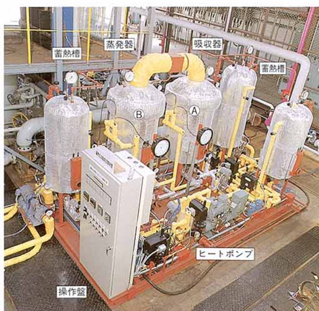
第2図 テスト装置 (冷暖房能力：約6,000kcal/h)
