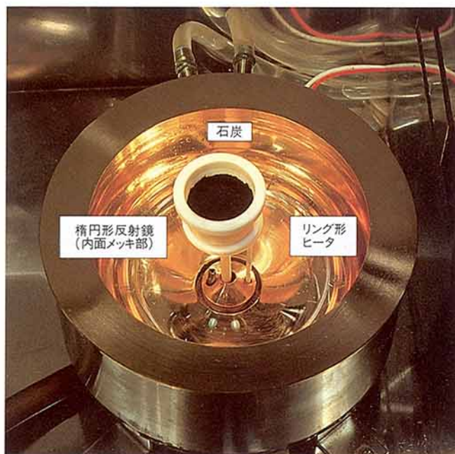
第2図 リング形ヒータと楕円形反射鏡
