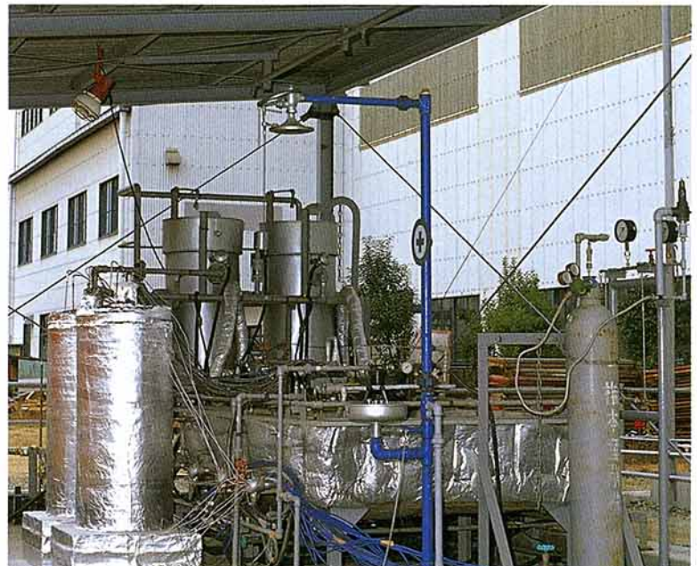
第2図 潜熱蓄熱材試験装置
