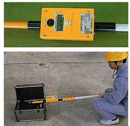
第2図 検電器と検電器チェッカ
