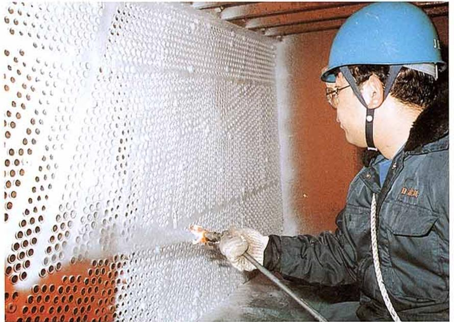
第2図 泡まつ液の管面板面への塗布状況
