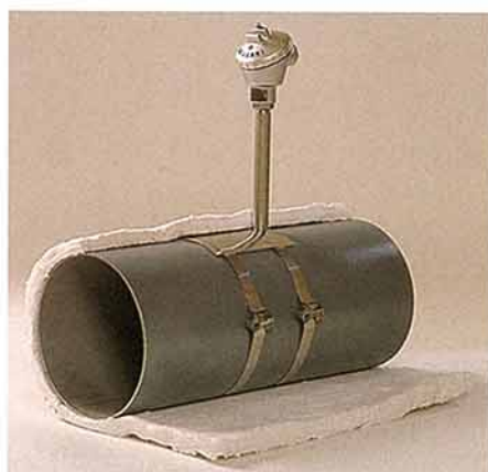
第2図 温度計の取付状態
