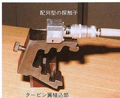
第1図 翼植え込み部に対する検査方法
