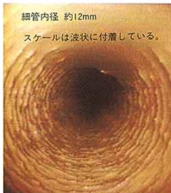
第1図 細管内面スケール付着状況(洗浄前)
